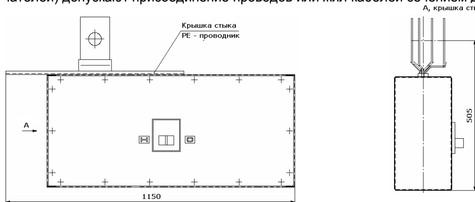
Рис. 2.14 Ответвительные секции с автоматическим выключателем.
